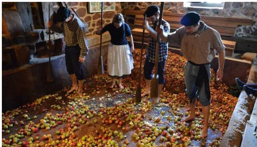
El troceado y machacado de manzanas en el lagar a ritmo de 'kirikoketa' con las artesanales mazas verticales. (J.M. ONDIKOL)
