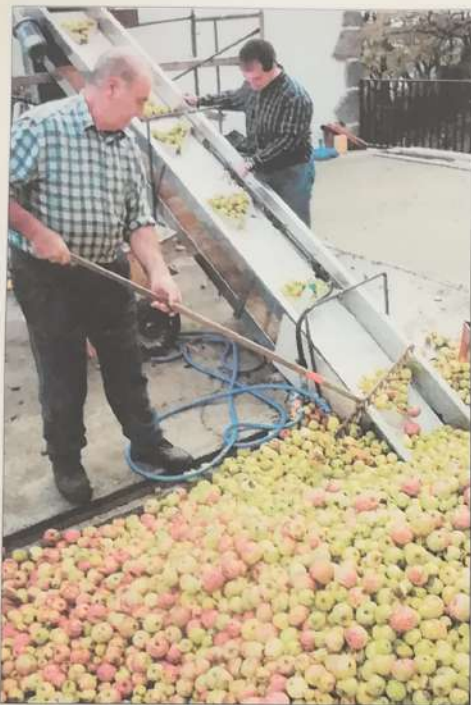
Una vez recogida la manzana se limpia en un canal de agua, se clasifica y se transporta mediante una cinta hasta la prensa.
