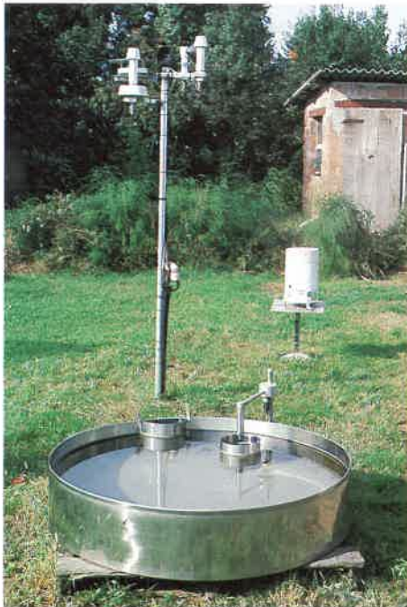
Tanque evaporímetro para cuantificar la evapotranspiración.
