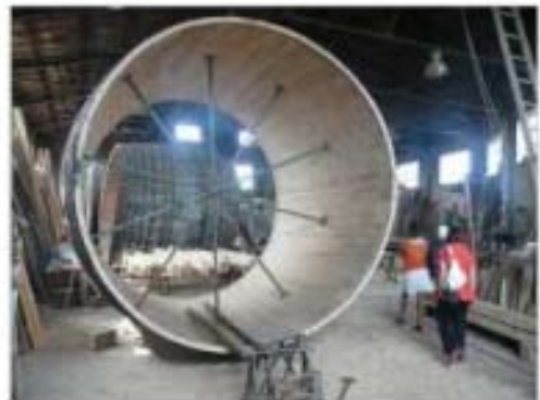
La gran kupela de 10.000 litros en su fase de construcción.
