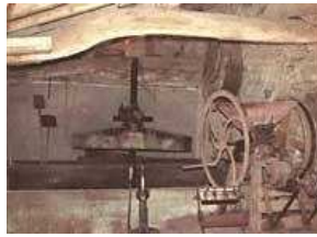
Usurbilgo Ibarrola-Berri baserriko tolaarea eta sagarra txikitze makina.
