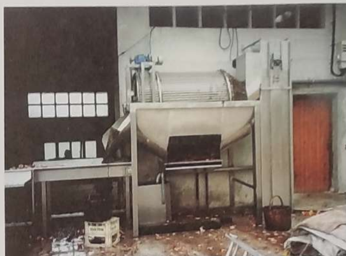
ALTZAIRUA ETA MOTORRA. Ezkerrean matxakaren hortzak eta eskuinean sagarra jaso, txikitu eta dolarera doa.
