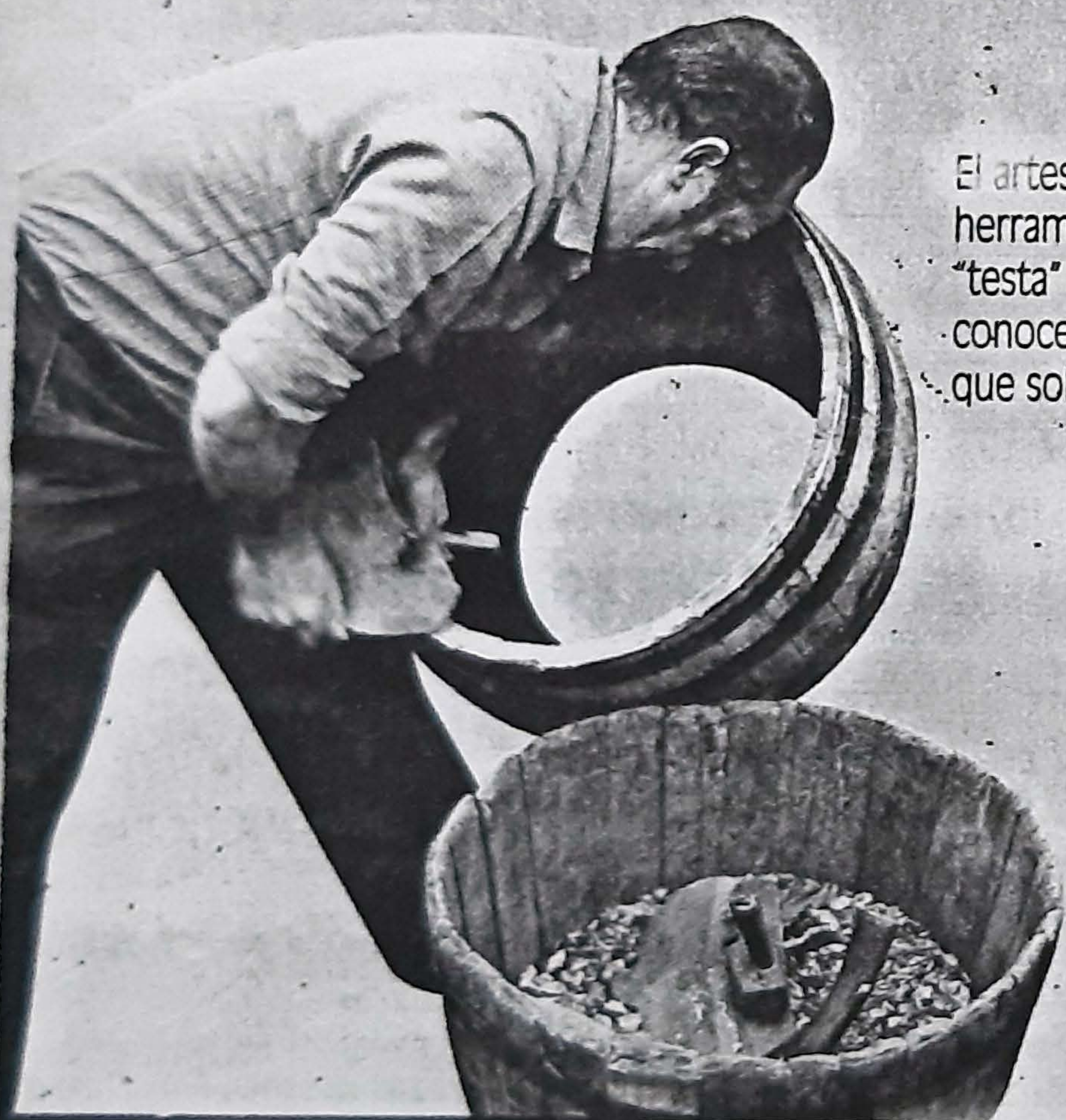
El tonel, bajo la acción del calor del fuego. En la parte inferior, la sirga con la que se tensa la madera hasta que las duelas se cierran.
