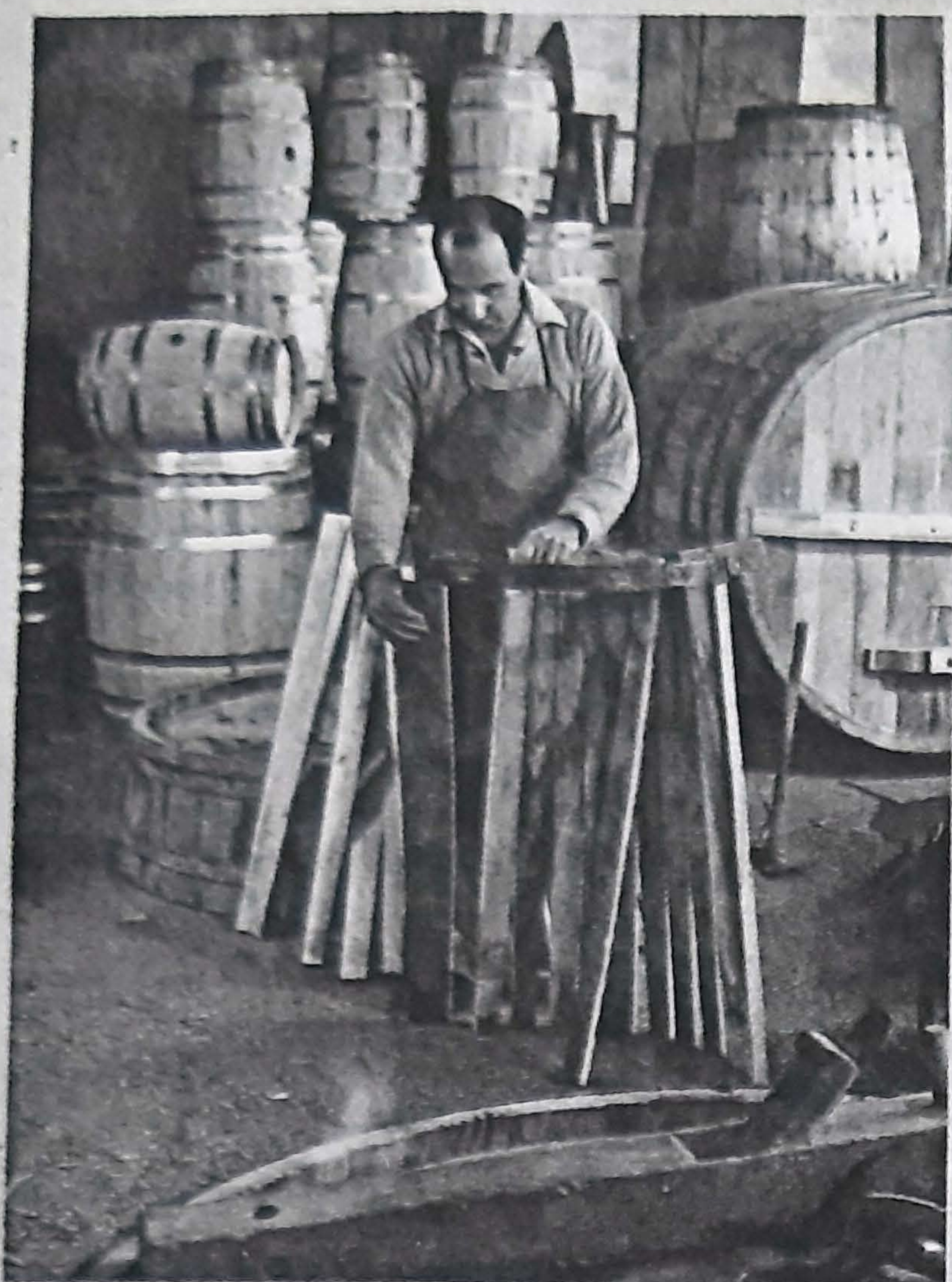
Momento en que el artesano va colocando las duelas formando un círculo, dentro del aro de hierro que sostiene con una de sus manos.
