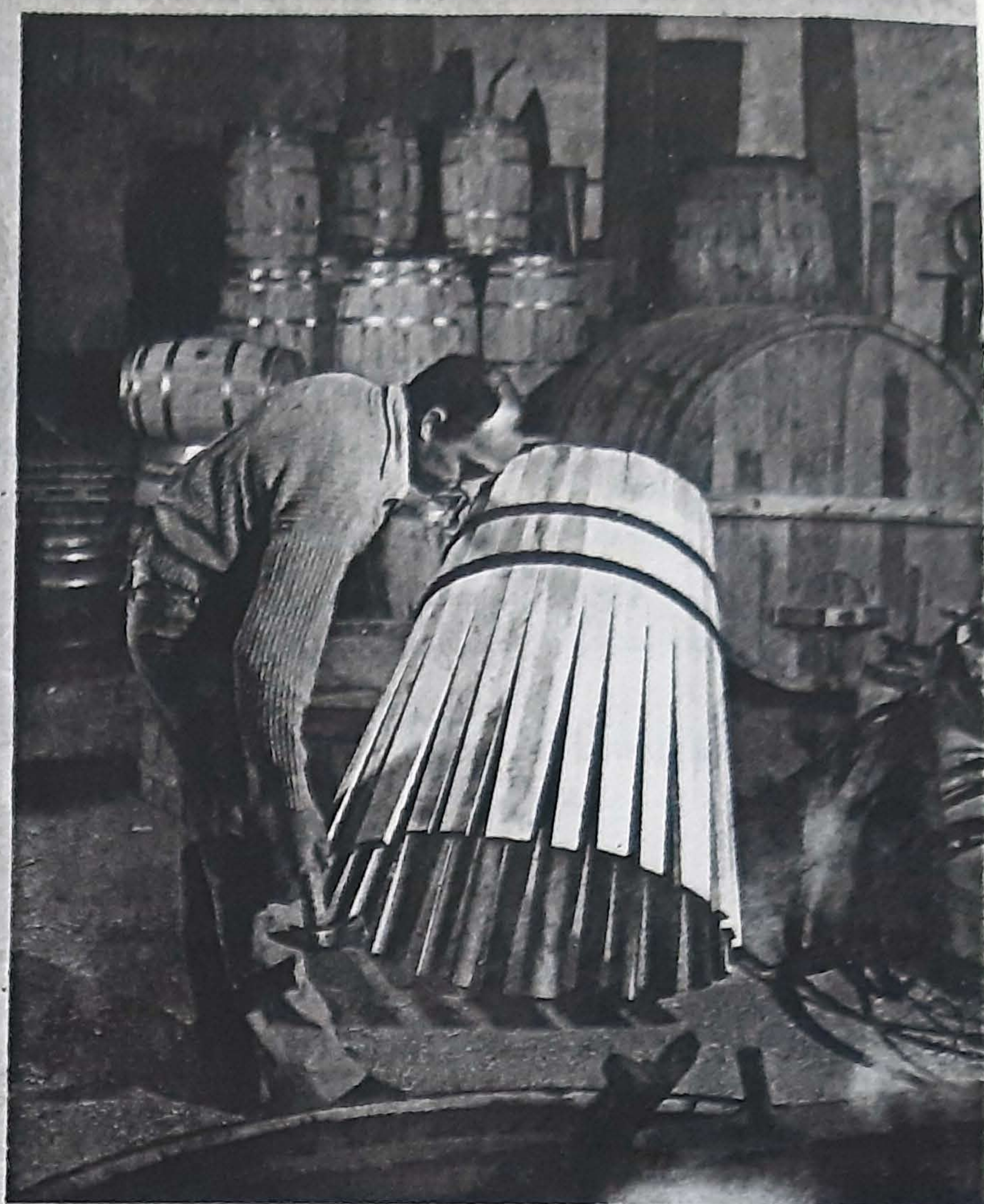
El artesano iguala con un martillo la longitud de las duelas antes de meterlas en el pozo con fuego para moldearlas y poner los aros de hierro.
