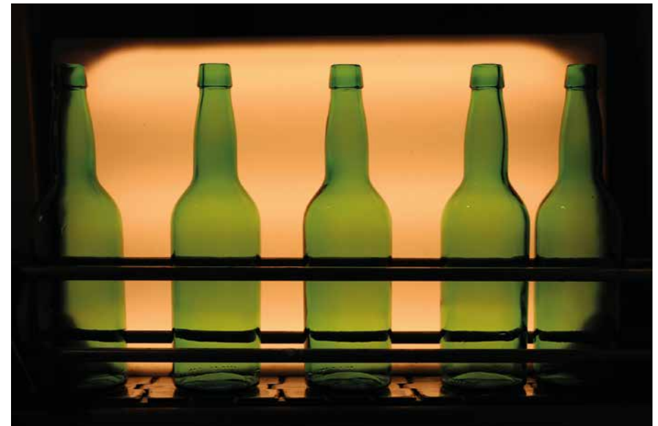
Pantalla de inspección para detectar suciedad o roturas después del lavado de las botellas reutilizadas
