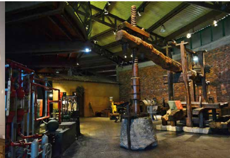
Llagar de pesa ubicado en el Museo de Nava Foto: J. Palacios
