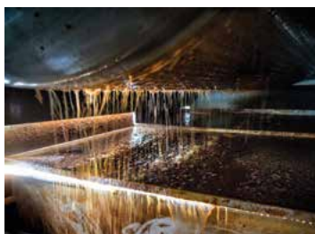
Detalle de prensa neumática pingando. Donde está saliendo el mosto
