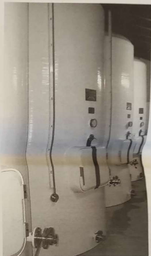
Las kupelas isotérmicas permiten controlar la temperatura.
